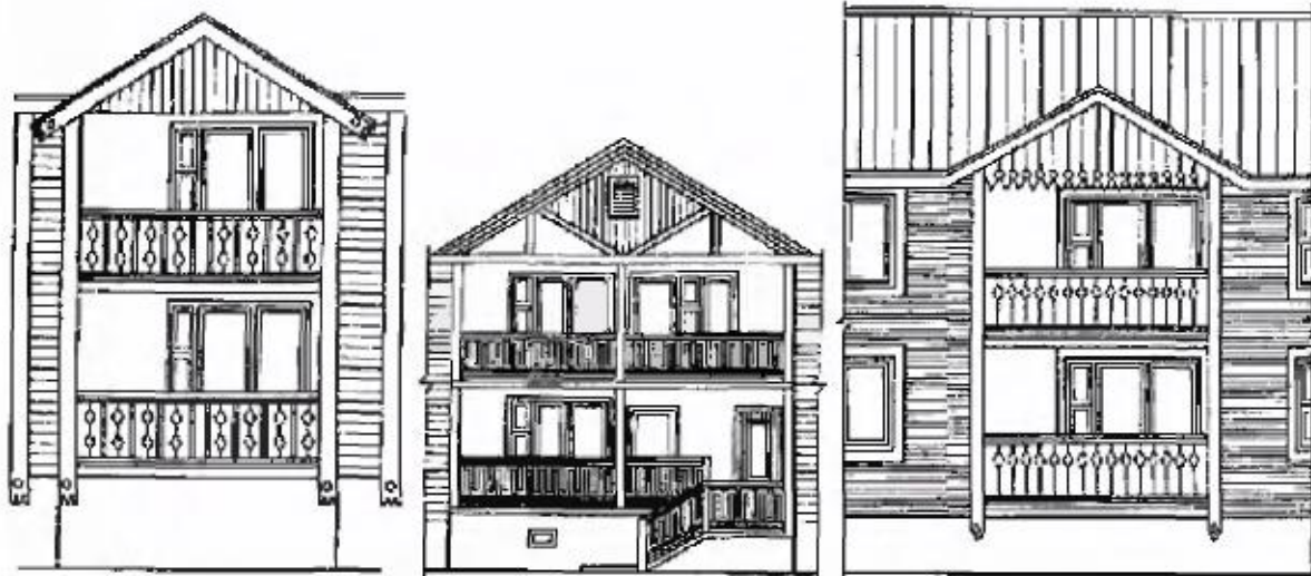
Рис. 9. Варианты оформления фасада жилого дома деревянно-панельной конструкции
